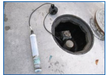
Detector de fuga para intersticio con agua salobre
